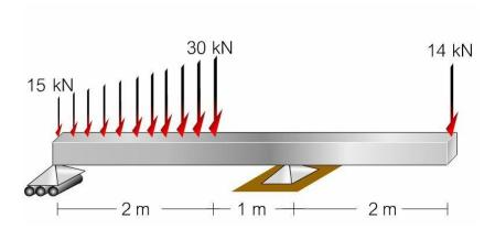
Figura (4.23) Viga sujeta a cargas
