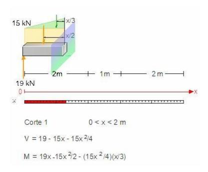
Figura (4.24) Descomposición de carga trapezoidal en una triangular y distribuida
