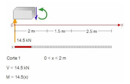
**Figura 4.11** Ecuaciones para V y M obtenidas para el primer corte
