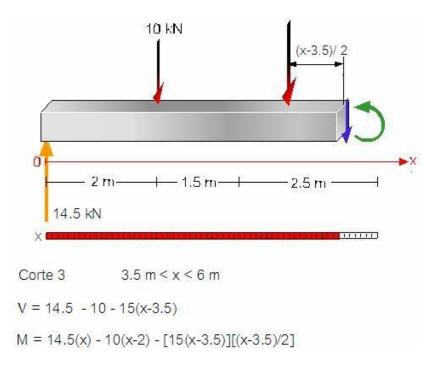
Figura 4.13 Ecuaciones para V y M obtenidas en el tercer corte
