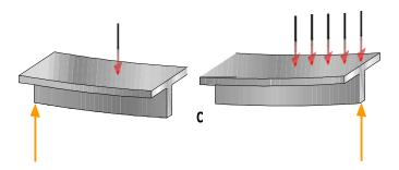
Se realiza un cambio de perspectiva para favorecer la visión de las acciones internas (Figura 4.4 a) que equilibran al cuerpo con las fuerzas externas aplicadas y, entonces, visualmente acciones las fuerzas V y M. Posteriormente se dibujan los esfuerzos que causa la flexión en la viga (Figura 4.4 b) y cuya obtención se estudiará en el capítulo siguiente.
