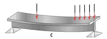
Figura 4.2 Flexión de la viga debido a cargas
