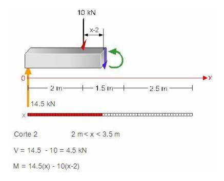
Figura 4.12 Ecuaciones para V y M obtenidas en el segundo corte
