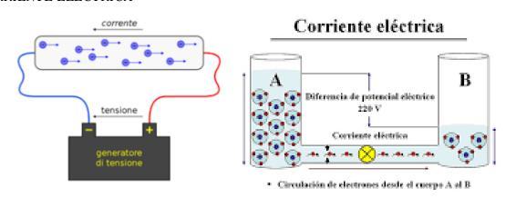
La cantidad de corriente que fluye depende del voltaje y de la resistencia del circuito. La fuerza que produce el flujo de corriente, causado por la diferencia de carga en los extremos del alambre, se llama voltaje. Este es otro aspecto de la electricidad y de los circuitos eléctricos que usted debe conocer. Todos los materiales se oponen en cierta medida al flujo de corriente, esta oposición se le llama resistencia.
