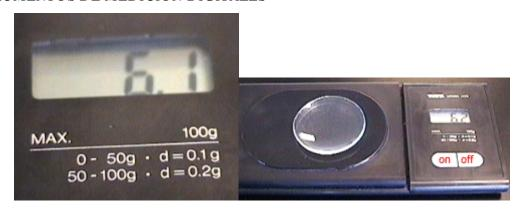
La imprecisión de los instrumentos de medida digitales la indica el fabricante. En la balanza de la figura se indica la cota máxima, o peso máximo, que puede medir y la imprecisión (d). Para pesadas entre 0 y 50 g la imprecisión es de 0,1 g, pero entre 50 y 100 g el fabricante sólo asegura 0,2 g.
