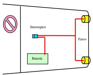
Para evitar esto se utilizan los relés, de forma que la corriente se dirige por la vía más corta desde la batería a través del relé hasta los faros. Desde el interruptor en el tablero hasta el relé es suficiente un conductor de mando de sólo 0,75 mm2, ya que el consumo es de unos 150 mA.
