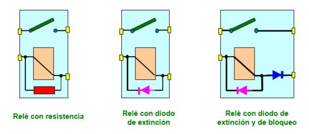
El objeto de la resistencia y del diodo es proteger al elemento de mando del relé de posibles corrientes autoinducidas, generadas en la propia bobina de excitación, que podrían dar lugar al deterioro de este.
