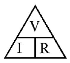
Por ejemplo, si el voltaje de la batería es de 12 voltios, la resistencia de los resistores es de 2 ohmios, la corriente será de 6 amperios.
