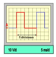
Calcular la frecuencia de las siguientes formas de onda
