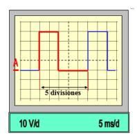
El circuito representado en la figura, tiene una cadencia de funcionamiento de 1mseg, es decir, el interruptor cambia de posición en ese intervalo de tiempo.
