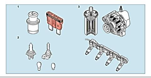
a) Función de emisión de luz b) Función de generación de calor c) Función magnéticach
