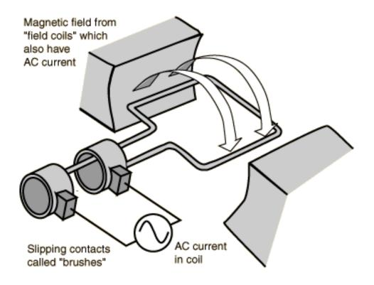
Son los más utilizados en la industria. Estos motores tienen la peculiaridad de que no precisan de un campo magnético en el rotor alimentado con corriente continua como en los casos del motor de corriente directa o del motor síncrono. Una fuente de corriente alterna (trifásica o monofásica) alimenta al estator.
