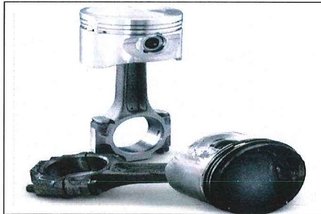
Imagen 1. Estructura de un pistón y biela, Automocionline 2018
