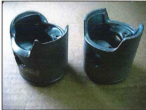
Imagen 5: Recortes de la falda del piston. (Ciclosargentinos 2011)
