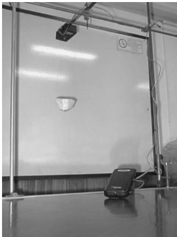
Figura 3. Arreglo experimental para determinar la velocidad en función del tiempo y velocidad límite, en su movimiento de caídas de un filtro de café sujeto a la fuerza de arrastre que ejerce el aire, registrada por un radar ultrasónico acoplado a una interfaz y computadora.
