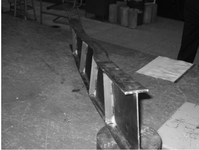
Fig. 12 – Ensayo a flexión con pandeo lateral-torsional
