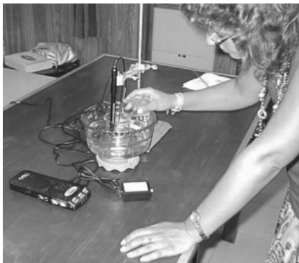
Figura 18. Arreglo experimental para medir consumo de oxígeno disuelto en solución de azúcar con levadura a temperatura ambiente.
