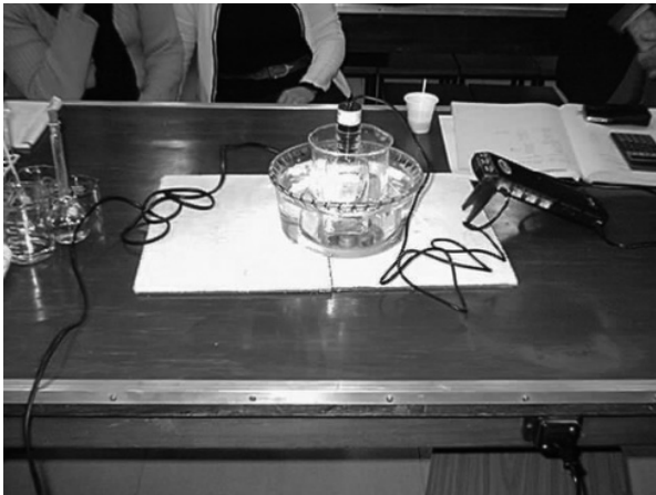
Figura 14. Arreglo experimental para medir porcentajes de oxígeno en función del tiempo, en un frasco hermético con baja humedad, donde se encuentra una hoja verde iluminada por una lámpara externa al frasco. El sensor de oxígeno se inserta en la boca del frasco.
