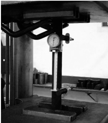
Fig. 5 –Medición de deformaciones para el relevamiento de las propiedades mecánicas del material (en las curvas aparece como barra aislada) y comparación de curvas de ensayo de una conexión versus simulación numérica (FEA)
