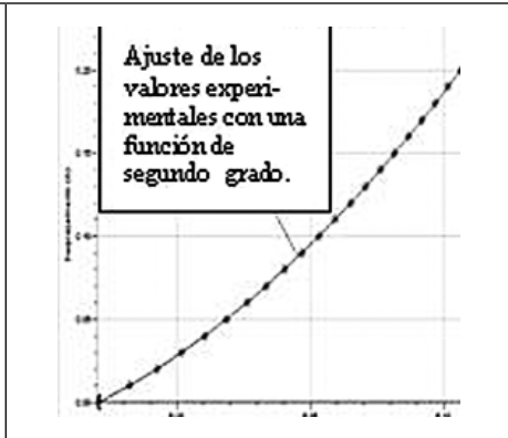
Figura 2. Representación gráfica de los desplazamientos D_i en función del tiempo, para el tiempo total del pasaje de la persiana por la foto compuerta en su movimiento de caída libre.
