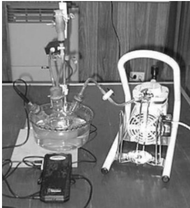
Figura 9. Arreglo experimental para determinar calores de vaporización correspondientes a diversos alcoholes. En la jeringa se introduce etanol, el cual se inyecta en el balón. Éste se sumerge en un baño de agua a diferentes temperaturas.
