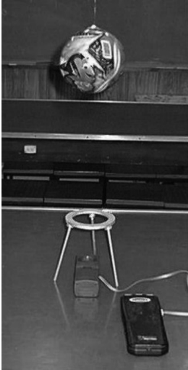
Figura 6. Arreglo experimental para determinar el desplazamiento y la velocidad de la pelota que cae libremente, por medio de un radar ultrasónico. Un programa representa ambas variables en función del tiempo.
